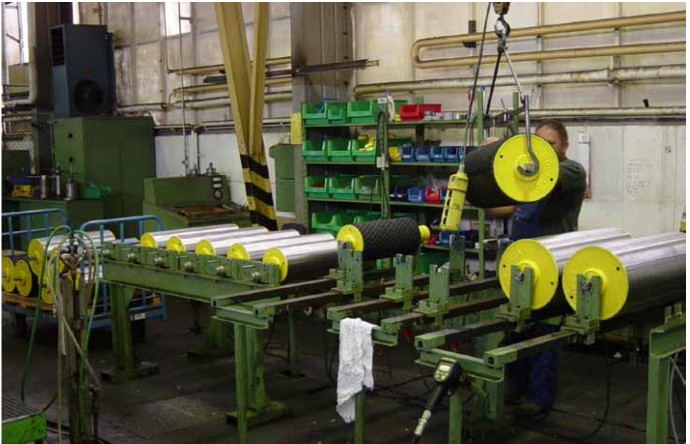
Trommelmotor voorzien van volkeramische bekleding
